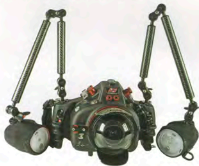
Una variante allo schema di luce per riprese con grandangolo a distanza ravvicinata e inquadratura orizzontale quando il soggetto non è a stretto contatto con il minidome e l'acqua ha molta sospensione.
